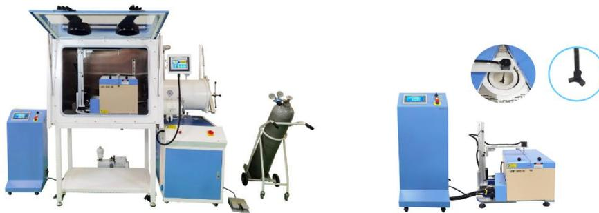
VBF-1100X-SV-RM 是一款坩埚熔炼炉，主要设计用于熔炼 Li,Mg,Al 和空气敏感性的合金，可在手套箱里使用，最高温度可达 1100°C。BN 搅拌桨和旋转电机（可往复上下移动），使熔炼合金更加均匀。此款设备特别适合制备一些合金，作为锂阳极，如 Li-3Al-1Yb 电极。
