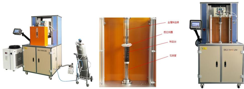
SKJ-ZM1650-500 是一款真空&气氛控制的区熔系统，用于材料提纯和定向凝固。设备安装有 10KW 超高频感应电源，可对金属棒快速加热和熔化。感应线圈和样品台都可以上下精密移动，用于可在同一个设备上尝试不同的生长晶体方法：顶部籽晶法，布里奇曼法和区熔法。
