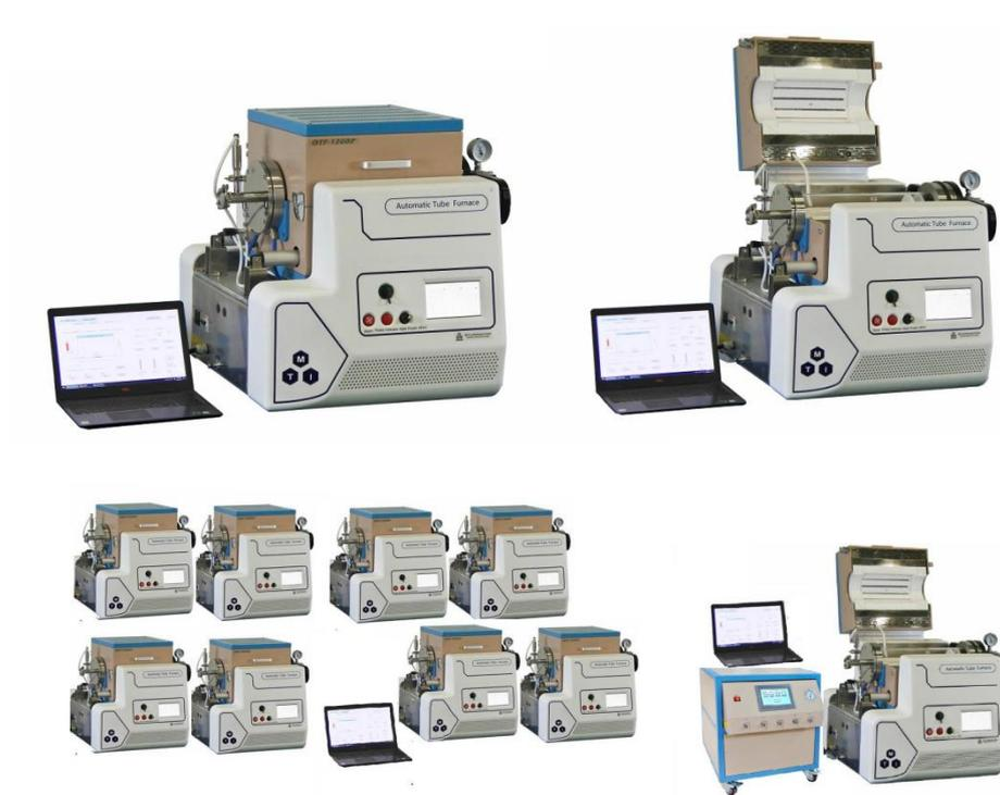
OTF-1200XS5-ASD 是一款炉管外径为 130mm 的自动管式炉，可以配合机器人使用。此款自动管式炉可做到真空密封，洗气，加热和冷却全部都按照设置好的程序自动运行。设备可配合电脑和机器人达到全自动操作，包括远程控制，数据记录，样品放置和样品取出。设备最高温度可达 1200℃。
