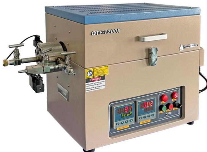
OTF-1200X-HP-55 是一款通过 CE 认证的开启式管式炉，炉管采用无缝镍基合金管。此款设备专为高温高压试验设计，最大压力可达 21MPa，最高温度可达 1100℃。对于高压制备新材料和作为小型热等静压炉处理合金样品是一款理想的设备。
